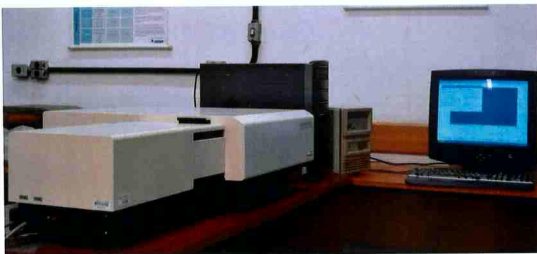
Figura 21 - Espectrofotômetro utilizado na análise de transmitância
