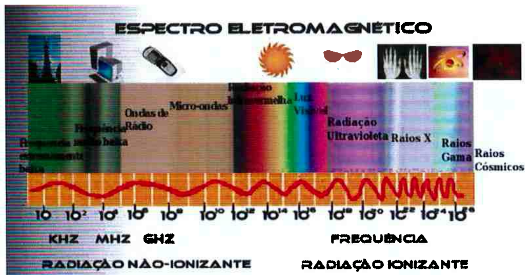
Figura 15 - Espectro eletromagnético (Explicatorium, 2016)
