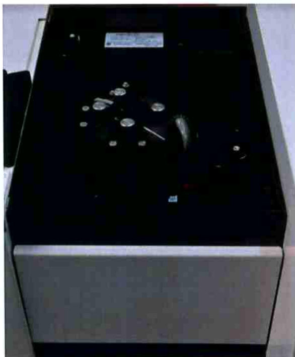
Figura 23 - Espectofotômetro utilizado na análise de transmitância (3)
